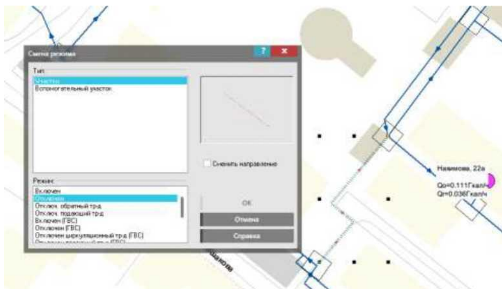
Рисунок 3.5.1. Пример моделирования отключения участка тепловой сети
