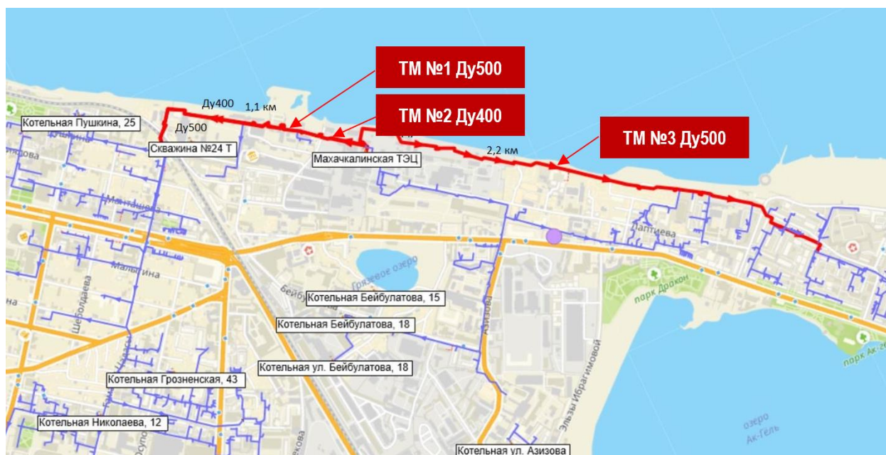
Рисунок 3.10.2. Фрагмент СЦТ от МТЭЦ с выделением тепломагистралей, истощивших свою пропускную способность
