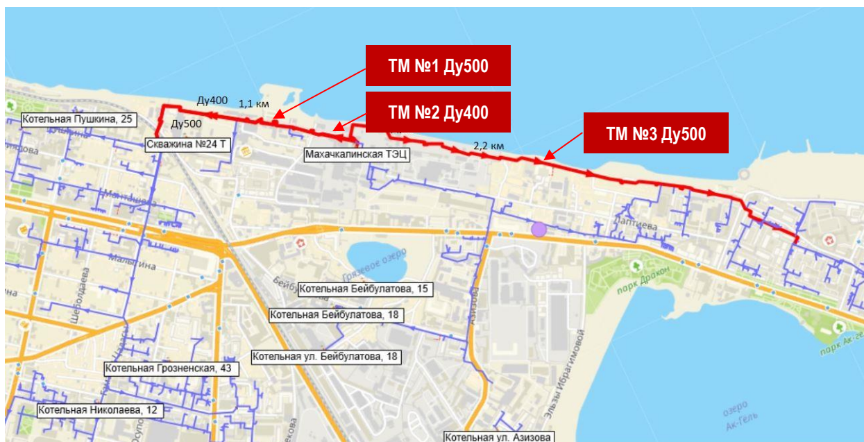
Рисунок 5.3.4. Фрагмент СЦТ от МТЭЦ с выделением тепломагистралей, исчерпавших свою пропускную способность
